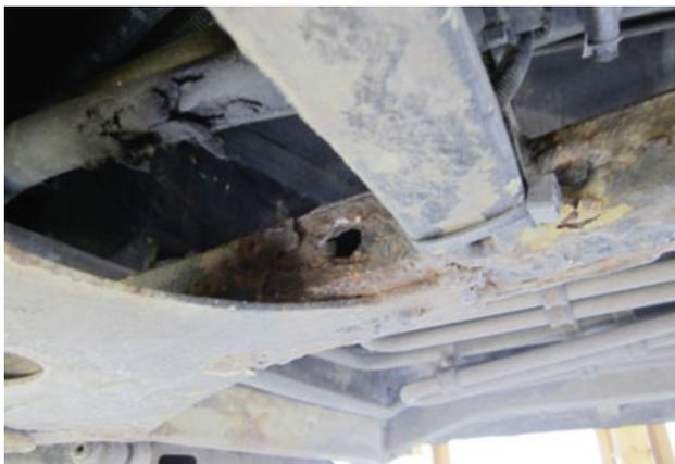
Rostschaden an tragenden Fahrzeugteilen
