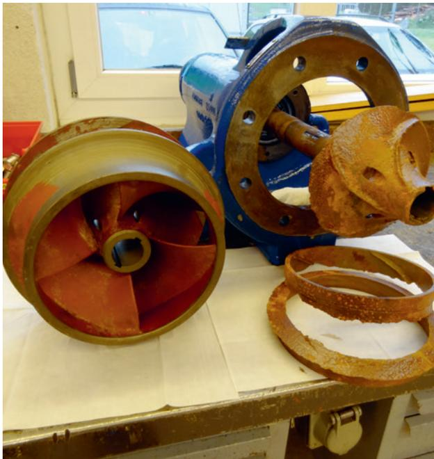
Rücklaufschlammpumpe: verschlissenes und neues Pumpenrad
