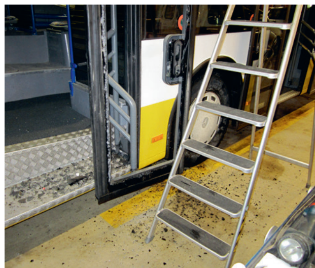
Defekte Türscheibe eines Gelenkbusses
