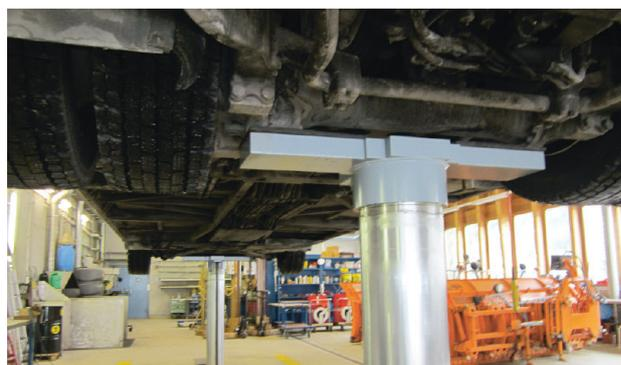
Gelenkbus auf den neuen Tragjochen (hellgraue Gussteile) des 3-Säulen-Lifts
