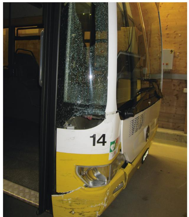
Defekte Ecke eines Gelenkbusses nach einem Zusammenstoss mit einem Personewagen
