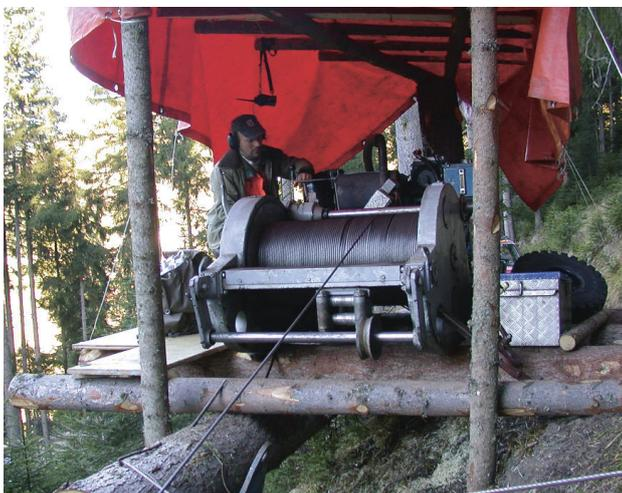
Seilwinde bei der Bergstation
