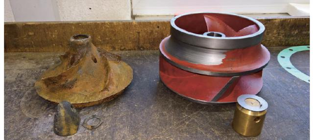
Rotor der Rücklaufschlammpumpe gebraucht (links) und neu (rechts)
