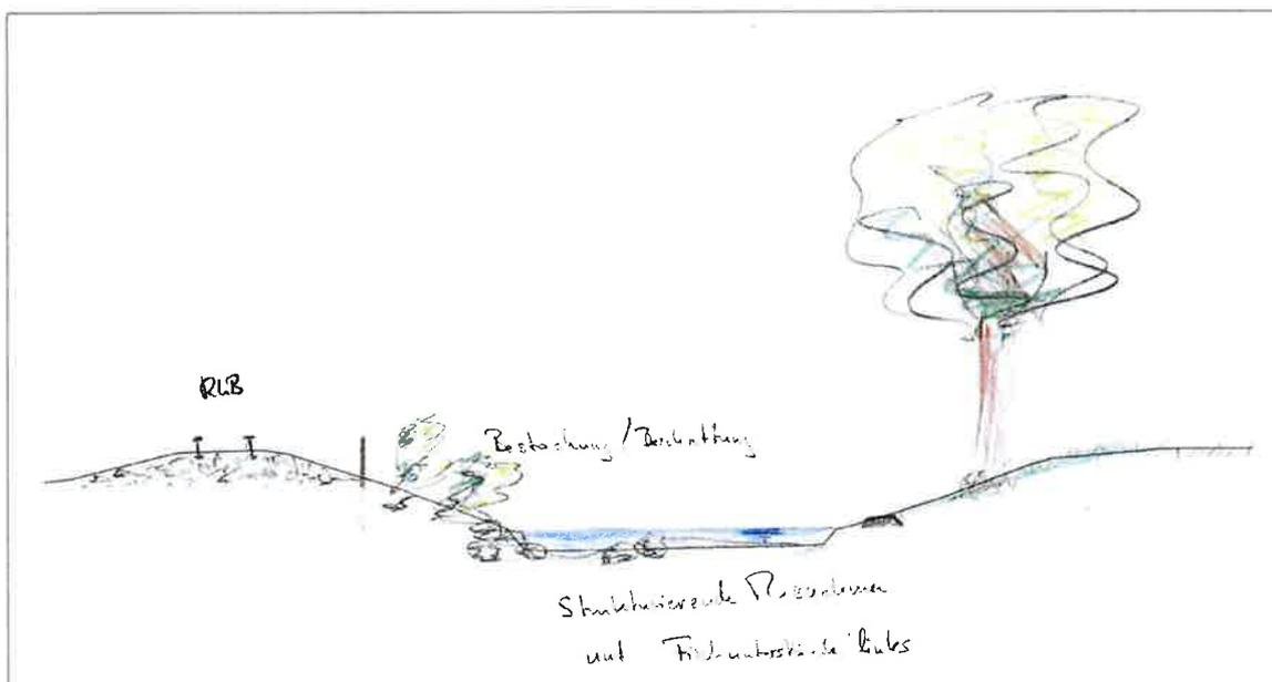
Abb. 31 AUFWERTUNG LINKES UFER UND GERINNESOHLA AM LANDWASSER IM UNTERSCHNITT
