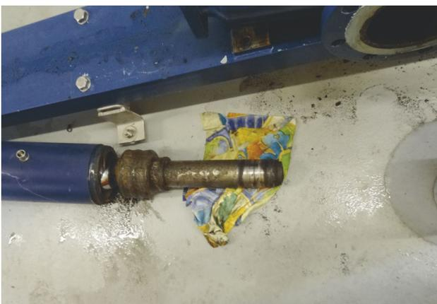
**Gebrochene Antriebswelle der Exzentrerschneckenpumpe**
