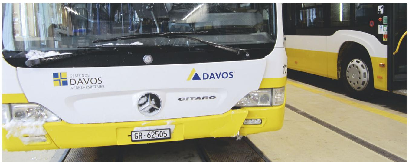
Defekte Busfront nach Rammung eines Pfostens der Strassenbeleuchtung
