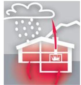
Ob das Radongas ins Haus eindringen kann, hängt in erster Linie davon ab, wie dicht das Haus im Kontakt gegenüber dem Untergrund ist. Risse und Fugen in Wänden und Böden, Öffnungen für die Durchführung von Kabeln und Rohren sowie Kellerböden aus Erde oder Kies (Naturkeller) stellen Eintrittsstellen für Radon dar.
