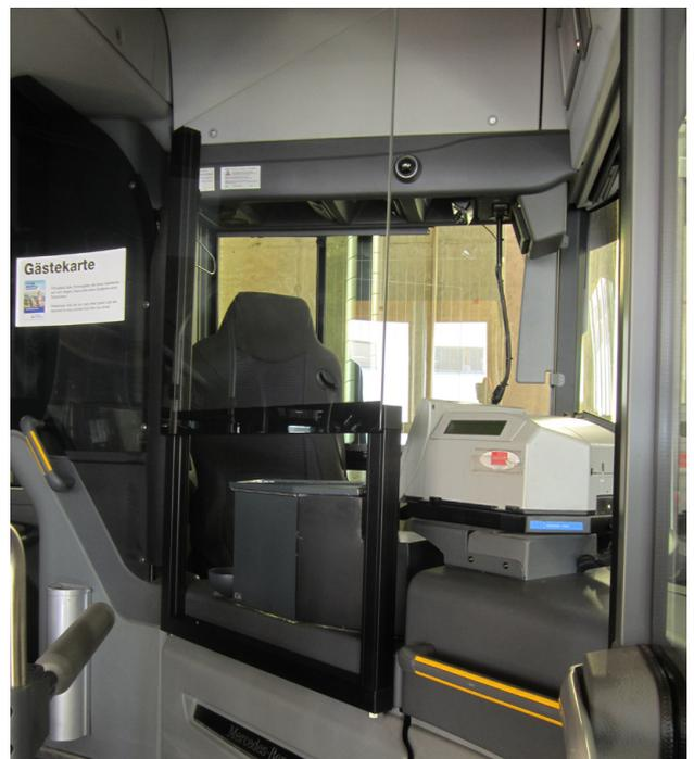
Neu montierte Fahrerschutzscheibe
