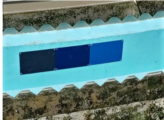
Montierte Versuchsplatten mit unterschiedlichen Beschichtungen
