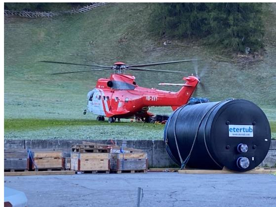
*Durch das hohe Gewicht des Sammelschachts und dem unwegsamen Gelände musste zum Transport des Sammelschachts (schwarz) ein Superpuma eingesetzt werden.*
