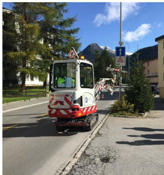
Mittels dem an einem Kleinbagger befestigten Prüfinstrument wird die Standfestigkeit der Kandelaber überprüft.
