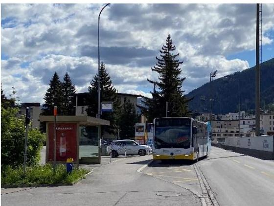
Abbildung 37: Busbuchten führen bei hohen Verkehrsbelastungen zu Verlustzeiten, im Bild: Haltestelle Tourismuszentrum
