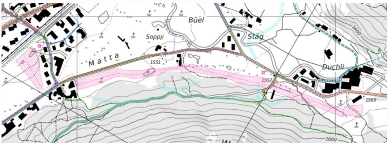
Abbildung 5: Auszug aus dem bestehenden Generellen Erschliessungsplan. In Pink ist die beschneite Loipenfläche sowie die Beschneigungsleitung eingetragen. Blau gestrichelt ist das Loipennetz eingetragen.
