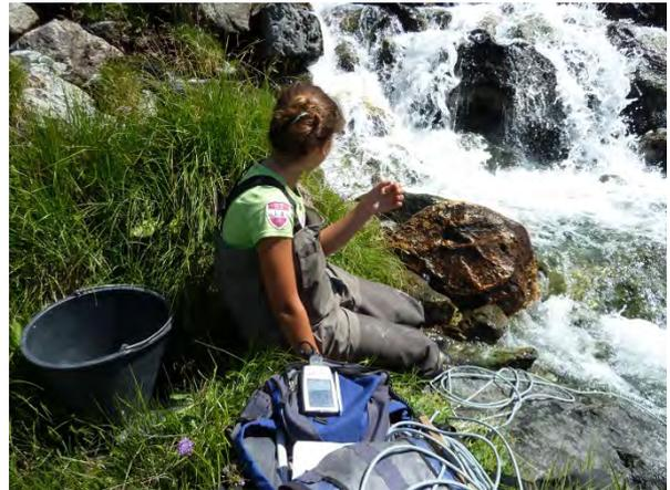
**Abbildung 10** Abflussmessung mittels Salzverdünnung
