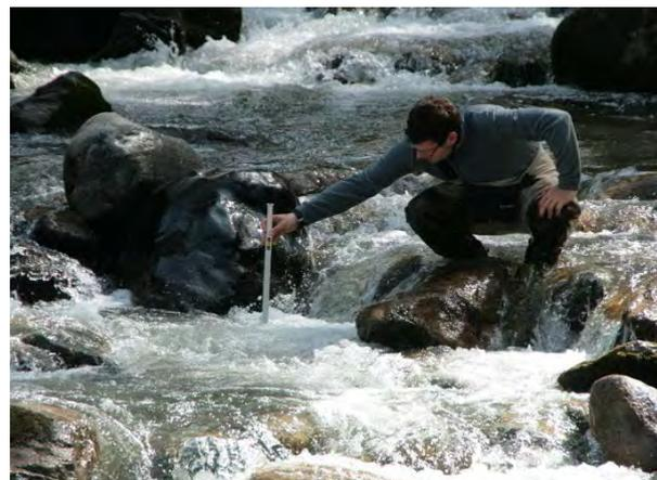
**Abbildung 8** Gewässeraufnahmen (Aufnahme der Wassertiefenvariabilität) am Sertigbach
