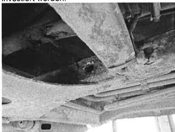
Rostschaden an tragenden Fahrzeugteilen
