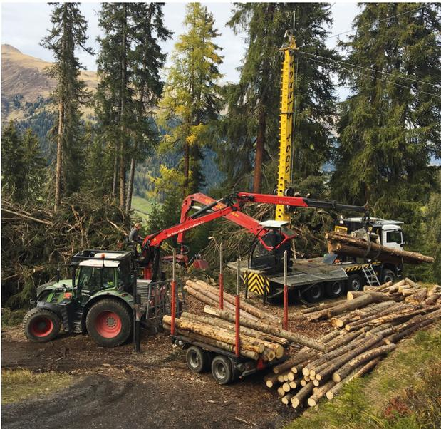
**Mechanisierte Holzernte mit Mobilseilkran**
