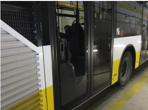
**Defekte Scheibe an der hintersten Türe nach einem Zwischenfall mit einem Skifahrer**
