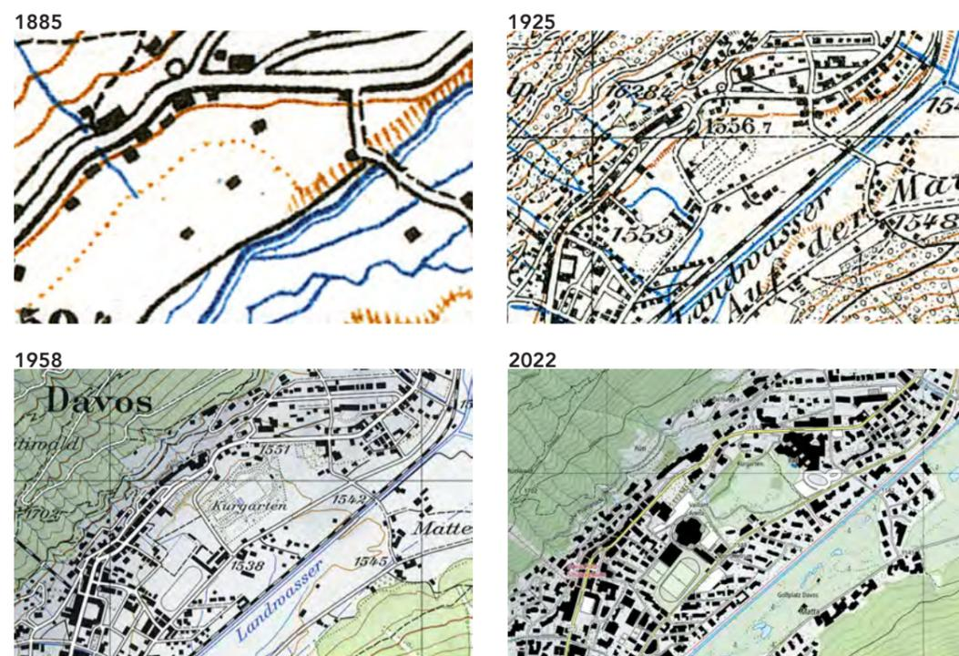
Abb. 25 | Entwicklung der inneren Freiräume: Kanalisierung des Landwasser, Trockenlegung der Riedflächen, Entstehung der Talstrasse, Bau des Kurgartens (1915-17), Anreicherung von grösstenteils Event-bezogenen Nutzungen an den Rändern.
