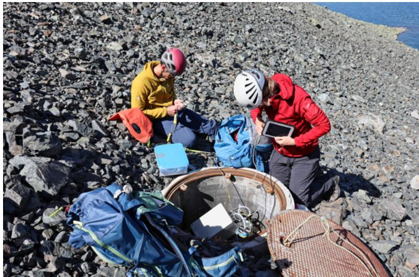
**Permafrost Monitoring: Das SLF misst am Flüelapass Bodentemperaturen in verschiedenen Tiefen. (Foto: Anouk Widmer)**
